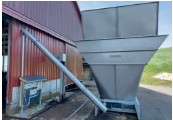
Bunker mit Förderschnecke
