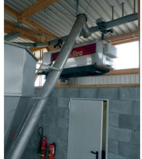
Bunker mit Förderschnecke für separierte Gülle, Sägemehl, gehäckseltes Stroh
